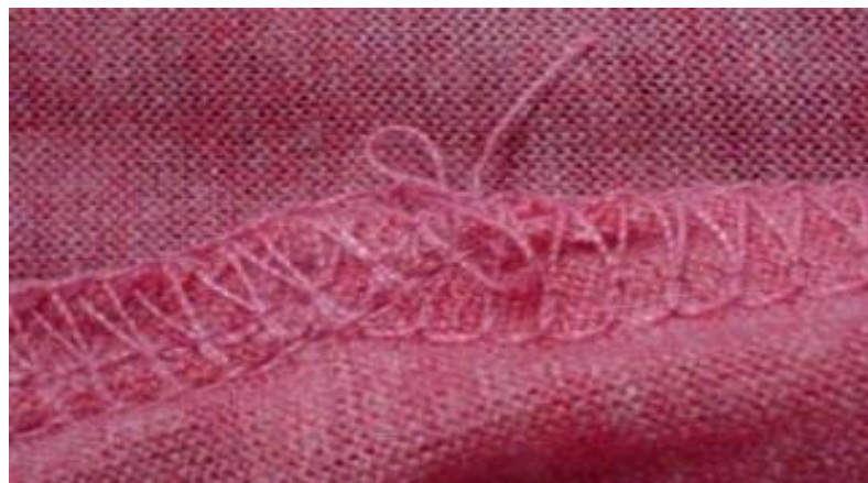
Gambar 4.2. Contoh jahit obras cacat minor
