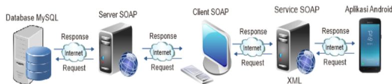
Gambar 5. Skema Komunikasi Web Service SOAP
