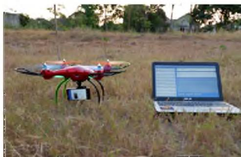
Gambar 8. Pengujian Koneksi *Camera Smartphone* pada *drone* Syma x8hg dengan Laptop
