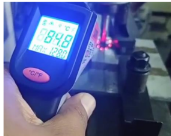
Gambar 3. Penyambungan FSW dengan pencatatan temperatur
