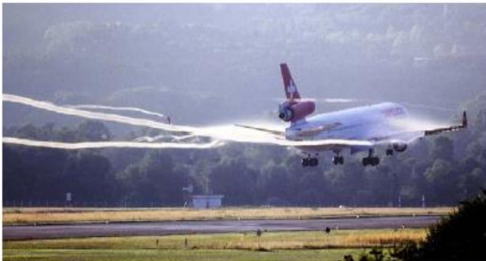
Gambar 3.5 Visualisasi aliran dengan asap pada ujung sayap dengan *winglet*. (Matshushita Masasi, Airlines. net Photo)
