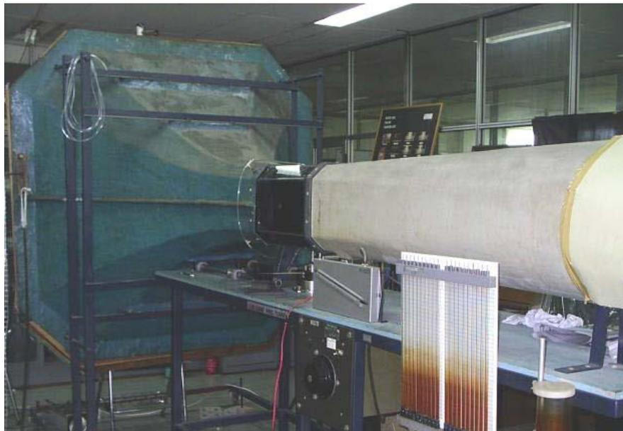
Gambar 5.2. Wind tunnel untuk pengujian ujung *winglet*
