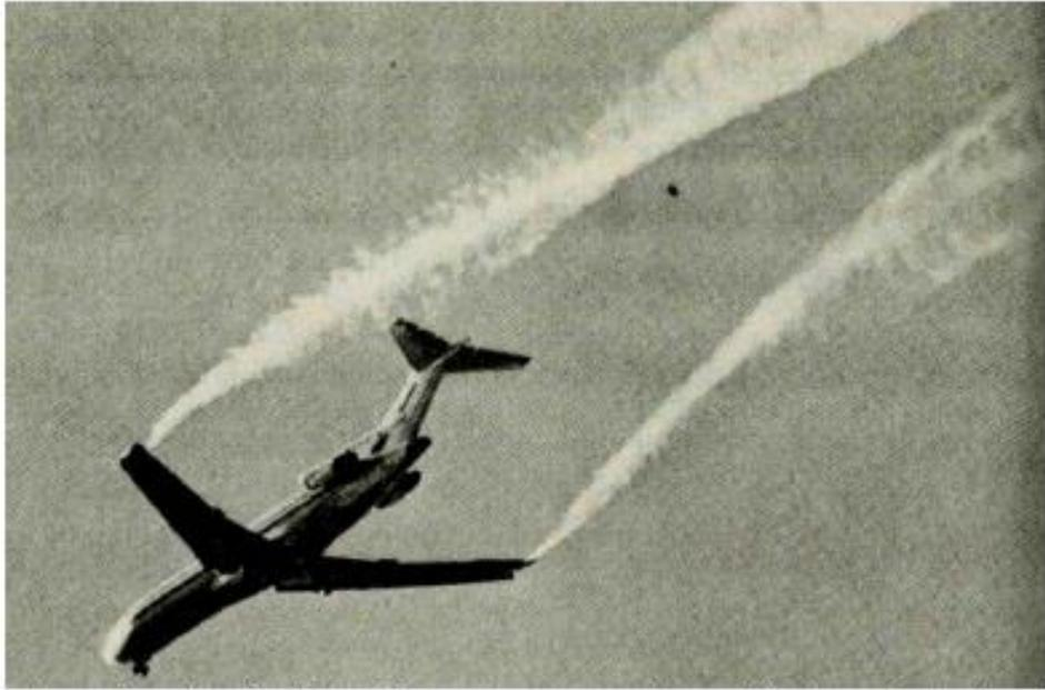
Gambar 3.4 Visualisasi aliran dengan asap untuk melihat pembentukan pusaran pada ujung sayap tanpa *winglet*. ( Anderson, 1985 )
