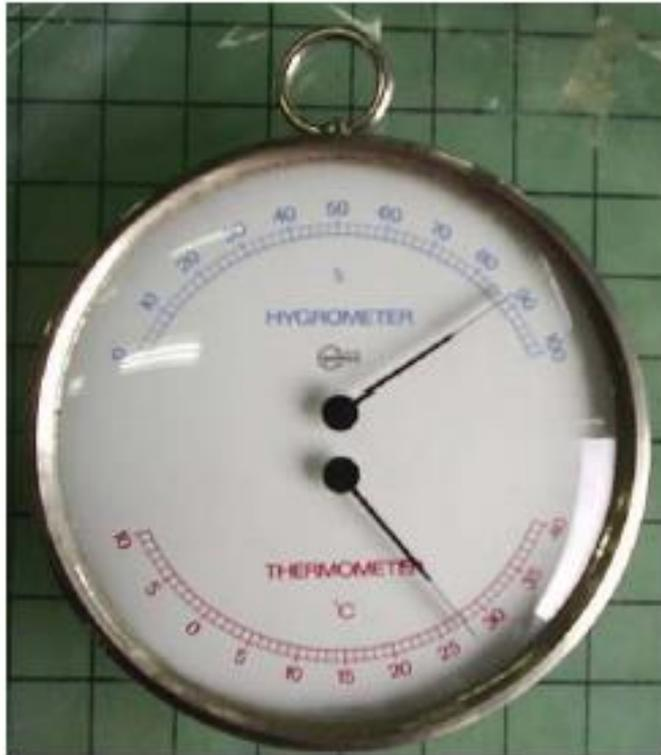
Gambar 5.7. Thermometer dan Hygrometer
