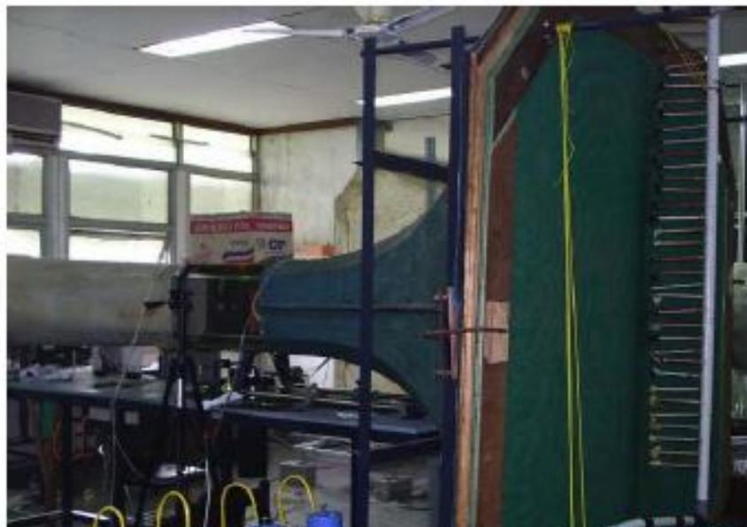
Gambar 5.4. Pipa-pipa pengarah asap ke dalam *wind tunnel*
