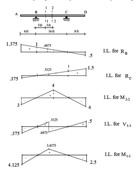
**Fig. E3.25c** Influence lines for  $R_{\rm B}$ ,  $R_{\rm C}$ ,  $V_{1\text{--}1}$ ,  $M_{2\text{--}2}$ , and  $M_{1\text{--}1}$
