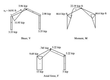
Fig. E4.10e Shear and moment diagrams
