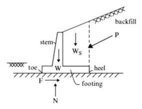
Fig. 8.3 Free body diagram—cantilever structure
