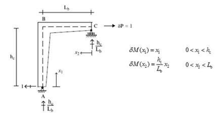
Fig. E4.14d  $\delta M$  for  $u_{\rm C}$
