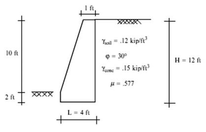
Fig. E8.1a Wall geometry
