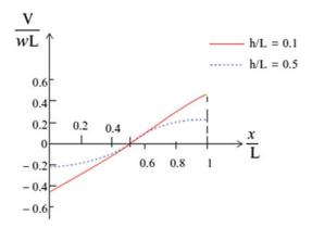
Fig. E6.1e Shear, V
