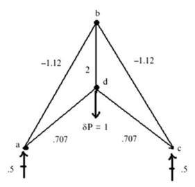
**Fig. E2.18b** Virtual forces  $\delta F$
