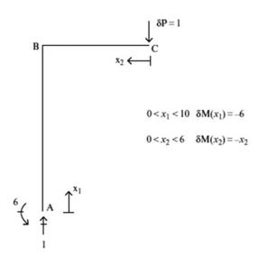
**Fig. E4.11d**  $\delta M(x)$  for  $v_c$
