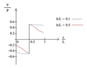
Fig. E6.2e Shear, V
