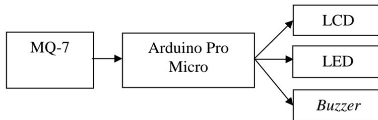
Gambar 3.1. Diagram Blok *System*
