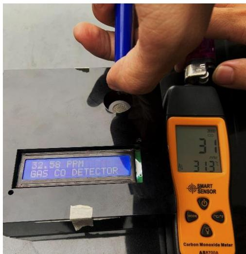
Gambar 4.9. Dokumentasi Pengujian Ketiga Kalibrasi
