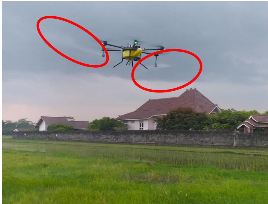
Gambar 1.1 Drone Penyemprot Pupuk (Sumber: Foto pribadi, 2022)
